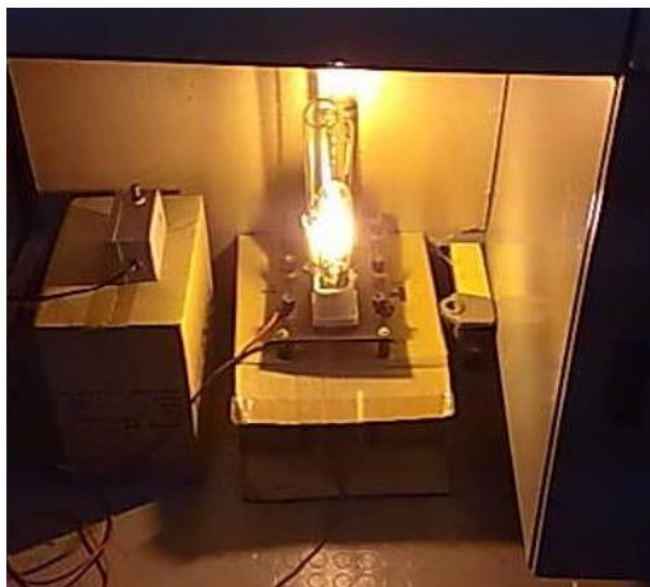
Widok lampy sodowej zasilanej z opracowanego statecznika elektronicznego
